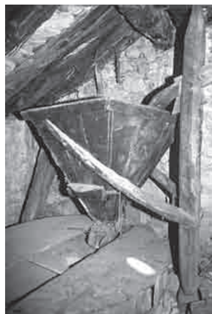
Tolva con canaleta
