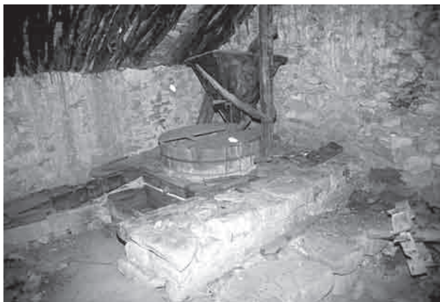
Sala de molienda con una pareja de muelas, un guardapolvo redondo, un harinal y una tolva rotatoria (Lacabazonada, 2011)
