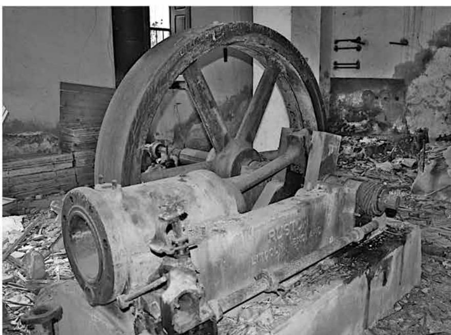
Motor diésel estacionario Ruston tipo 6XHR de Lincoln, Inglaterra
