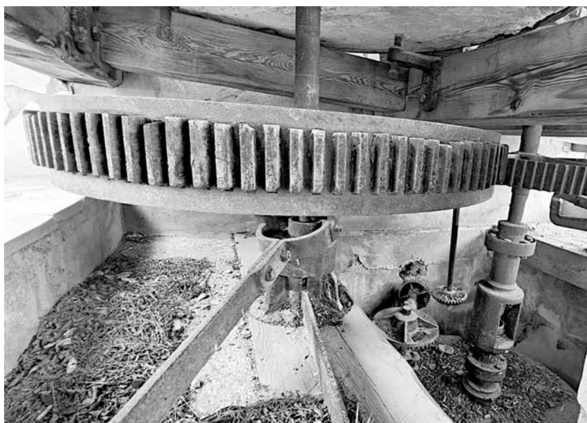
Engranaje con dientes de madera; abajo a la derecha la turbina Fontaine
